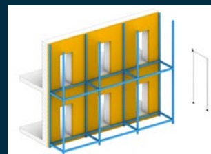
Figura 28: Demolizione e ricostruzione balconi con castello di carico
